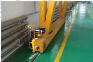
C型柔性直驱，节省空间 Type C gearmotor
